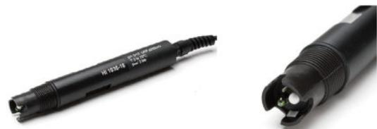
内置温度探头和匹配引针，匹配引针可消除接地环路电磁干扰。特殊玻璃材质 pH 感应膜，优选光滑铂金 ORP 感应探头，保证在低电导水样和恶劣测量环境中也可获得精确测量结果。测量读数自动温度补偿，通过数字信号传送到控制器，减少噪音和静电干扰，保证测量精准可靠。
