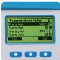
pH、ORP、温度高低值报警功能，报警启动时加药停止。超时加药保护功能，加药一定时间内测量值不在有效范围内时系统启动报警。
