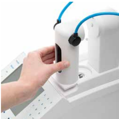
优化的 Clip-Lock™ 可更换滴管系统
