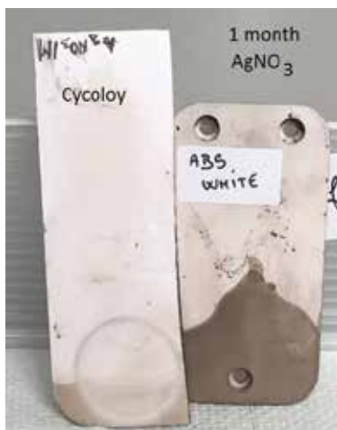
更耐用的 Cycoloy 材质，抗化学腐蚀
