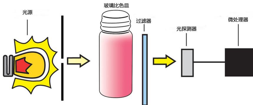
氰化物【CN】是一种主要源于冶金和电池工业制造厂的污染物。氰化物对于人体的神经系统是非常有毒的。因此，监控饮用水中氰化物的含量对于水质控制非常重要。对于污水排出口口的连续监测是非常有必要的，氰化物可以使用碱性氯化法处理。
