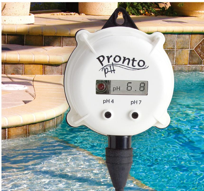
壁挂式防水设计 , 报警 LED 灯 ,LCD 显示屏。配置 HI1286PEI 材质酸度 pH 电极 , 耐化学腐蚀 , 独特 PTFE 防堵塞透析膜保护套设计 , 保证测量精准 , 延长电极使用寿命。手动两点校准 , 报警提醒功能 , 报警点设置范围为 3-11pH , 超出设定点  $\pm 0.5\text{pH}$  红色 LED 灯亮提醒。
