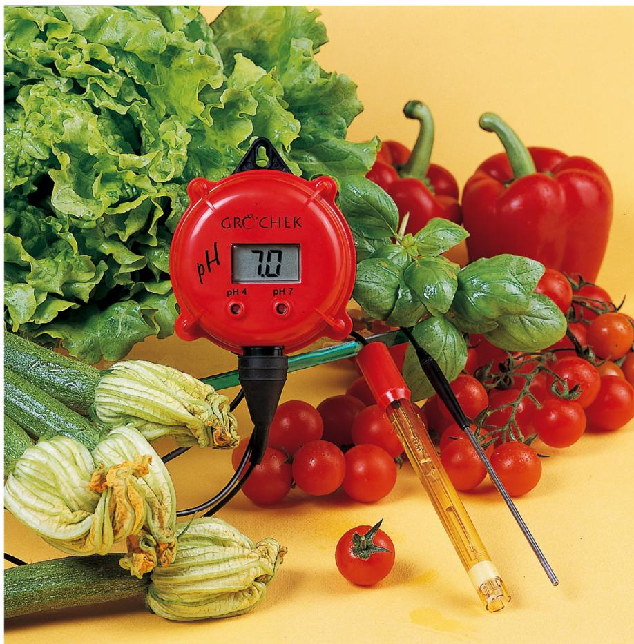
壁挂式，防水设计，操作便捷；pH4.01、7.01一至两点酸度手动校准。配备 HI1286 酸度 pH 电极，PEI 材质，PTFE 防阻塞透析膜保护套，耐化肥溶液，土壤溶液中磷酸盐，硝酸盐等高浓度植物营养溶液的化学腐蚀，保证测量精准，延长电极使用寿命。适用于水培业、温室和园艺业酸度 pH 连续测定。
